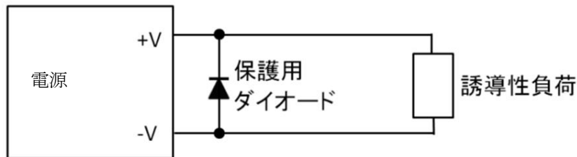
図7-5 誘導性負荷への接続
