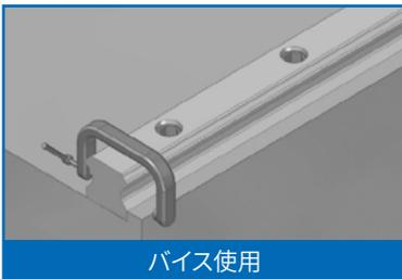
取付ボルトを仮締めした後、Cバイスで基準レールを基準面に押し込みます。順番に沿って取り付けボルトを記載されたトルクで締結します。
