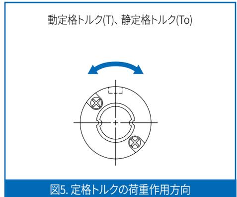
図5. 定格トルクの荷重作用方向
